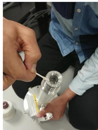
その後、日常に行えるメンテナンスとして、スピナロータ、プローブ、分光計フィルタの清掃について説明があった。スピナロータおよびプローブについては実際にエタノールで汚れを拭き取った。また、プローブの取り外し方法については取扱説明書にも記載がない事項なので、実際に拝見できたことは大変貴重で勉強になった。
