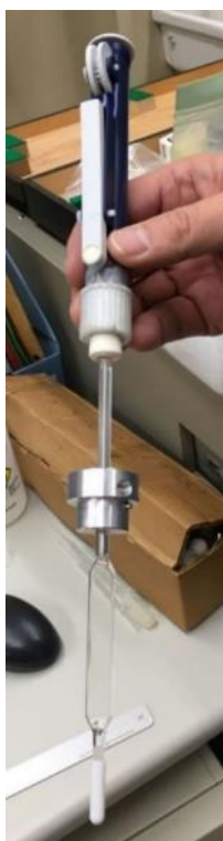
図 1 1 扁平セル (JEOL 製水溶液セル・ES-LC12)
