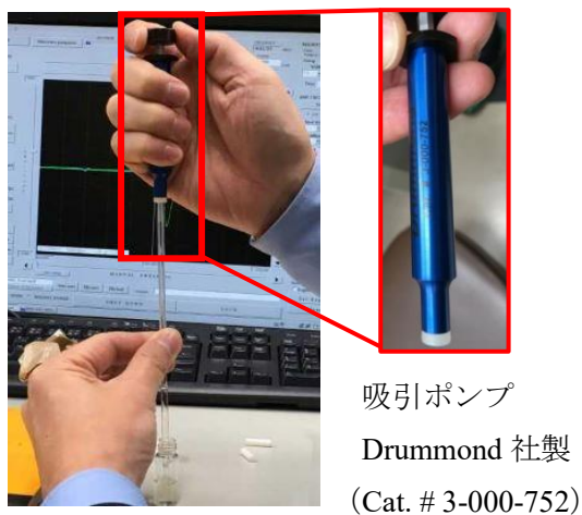
図 4 吸引ポンプを用いて扁平セル（JEOL 製）に TEMPO を吸引する様子
